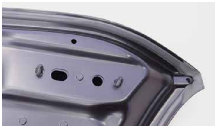
Originálna kapota motora Volkswagen s utesnením falcu.
