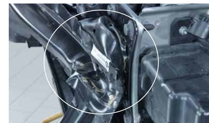
Golf VII s dielmi IAM. Crash box po náraze stlačený o 80 mm.
