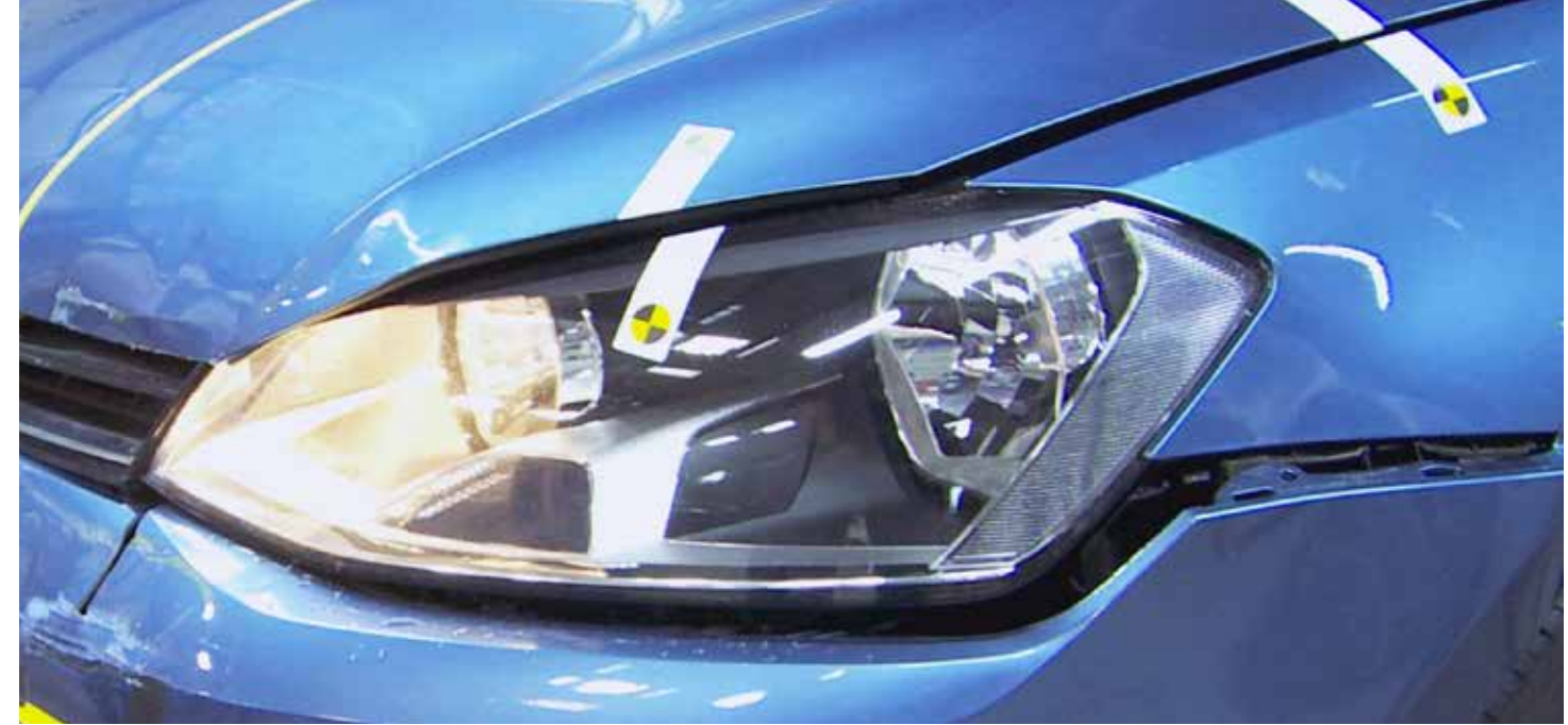
Golf VII s Originálnymi dielmi. Deformácie po crash teste.
