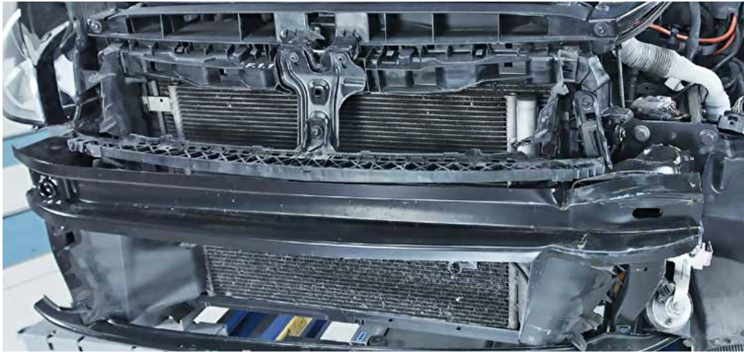
Golf VII s Originálnymi dielmi. Poškodenie prednej časti po crash teste.
