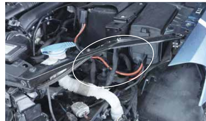
Golf VII s Originálnymi dielmi. Držiak prednej masky po crash teste: mierne ohnutý.
