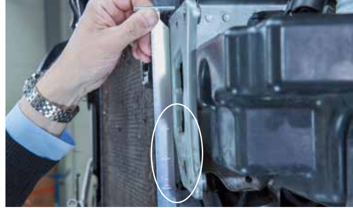
Golf VII s dielmi IAM. Príruba po crash teste: vyrovnávanie je potrebné.
