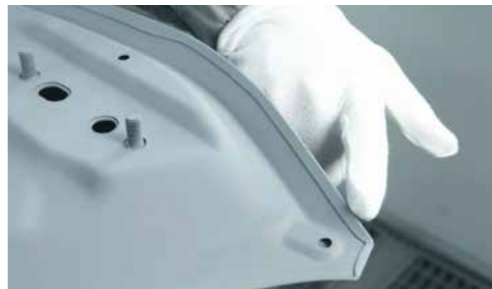
Kapota motora IAM výrobcu Tong Yang Group bez utesnenia falcu.
