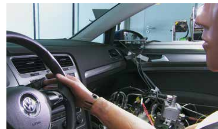
Interiér Golf VII s Originálnymi dielmi po crash teste. Airbag neaktivovaný.
