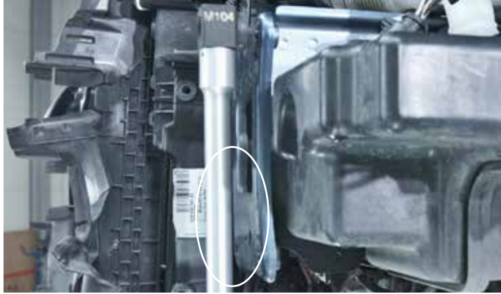
Golf VII s Originálnymi dielmi. Príruba po crash teste: nie je potrebné nijaké vyrovnávanie.
