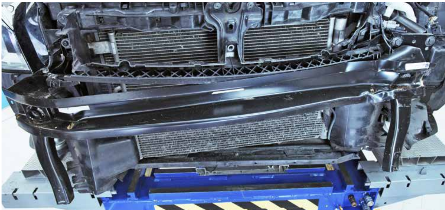
Golf VII s dielmi IAM. Poškodenie prednej časti po crash teste.
