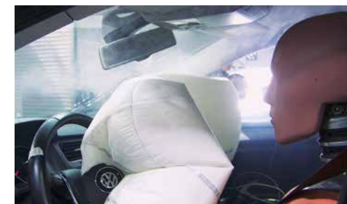
Interiér Golf VII s dielmi IAM po crash teste. Airbag aktivovaný.
